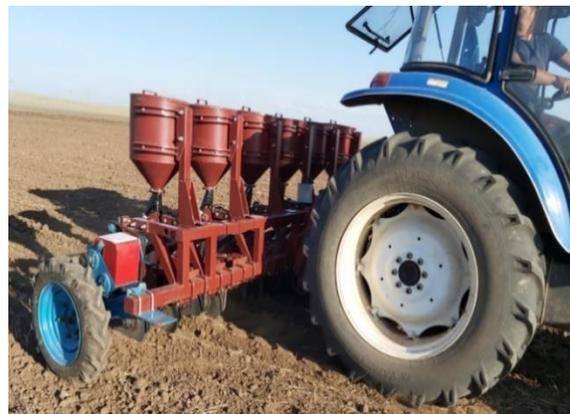
Рис. 46 - Экспериментальный образец сеялки с интеллектуальным блоком управления технологическим процессом посева нессыпучих семян трав на опытном поле в КХ "Гульдана"
