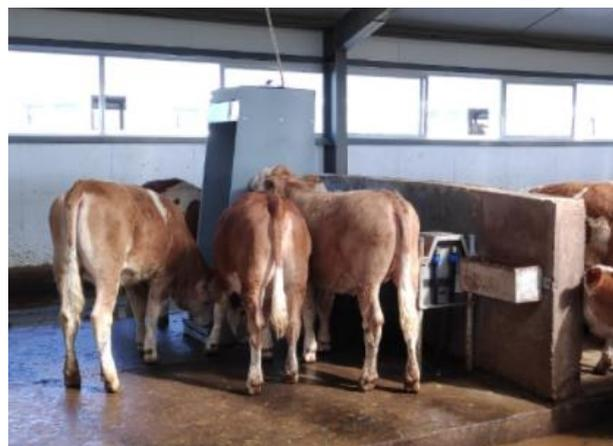
Рис. 58 – Оборудование для контроля живой массы КРС при подходе к поилке
