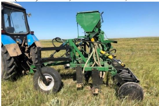
Рис.44 - Экспериментальный образец зернотукотравяной сеялки
